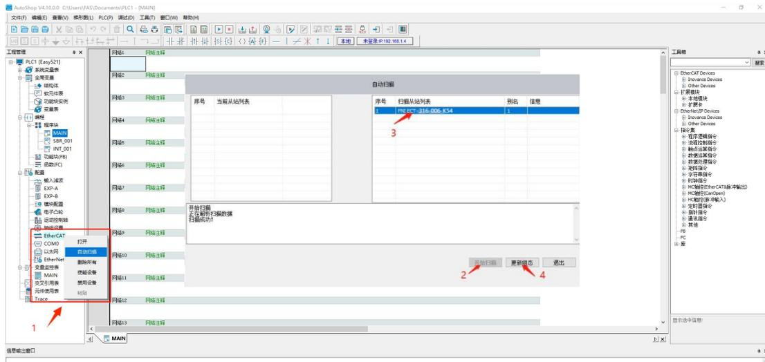
5、双击左侧设备框中的模块，点击 I/O 功能映射，就可以找到映射的地址；
