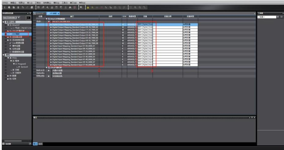
7、点击 PLC 在线模式按钮，组态界面显示控制器状态在线下再右键主设备，写入设备节点地址，注意节点地址需要与之前的 EtherCAT 从站设备一致；
