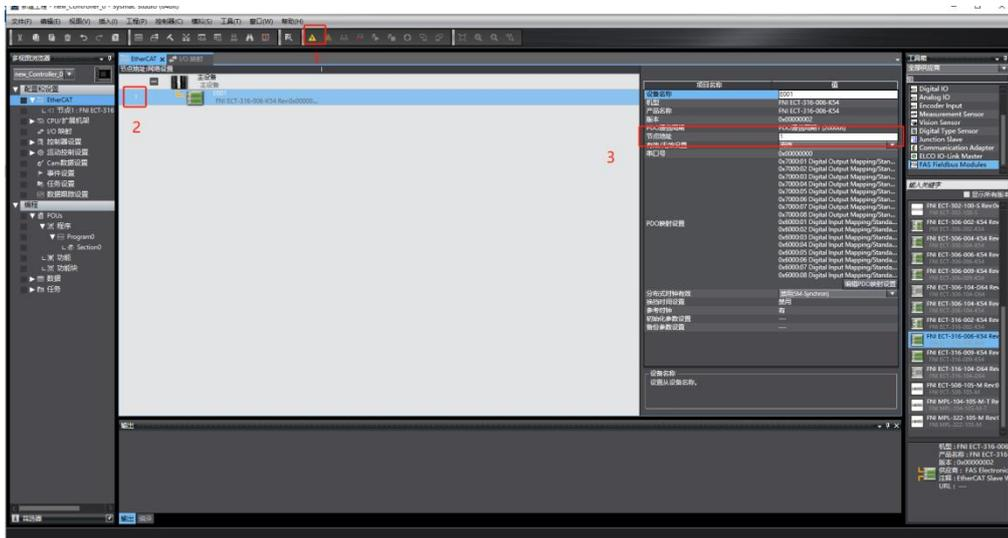
8、在菜单栏中找到控制器，传送到控制器中，下载到 PLC，并同意确认；
