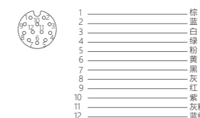
插头针脚布置及接线图
